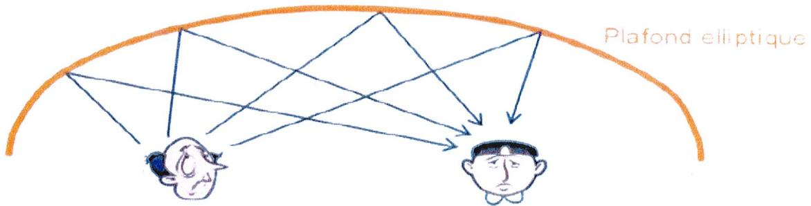
En se réfléchissant sur le plafond dont la forme est elliptique, les ondes sonores se propagent d'un foyer à l'autre.
